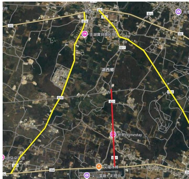
澎 17 線鄉道施工期間替代道路：1.紅色(澎 17 線鄉道)：施工封閉路段。2.黃色(澎 15 線及澎 19 線鄉道)：一般轎車及載重車輛替代道路。
