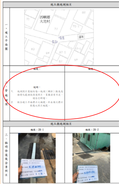
自主查核表缺少管線埋深照片
