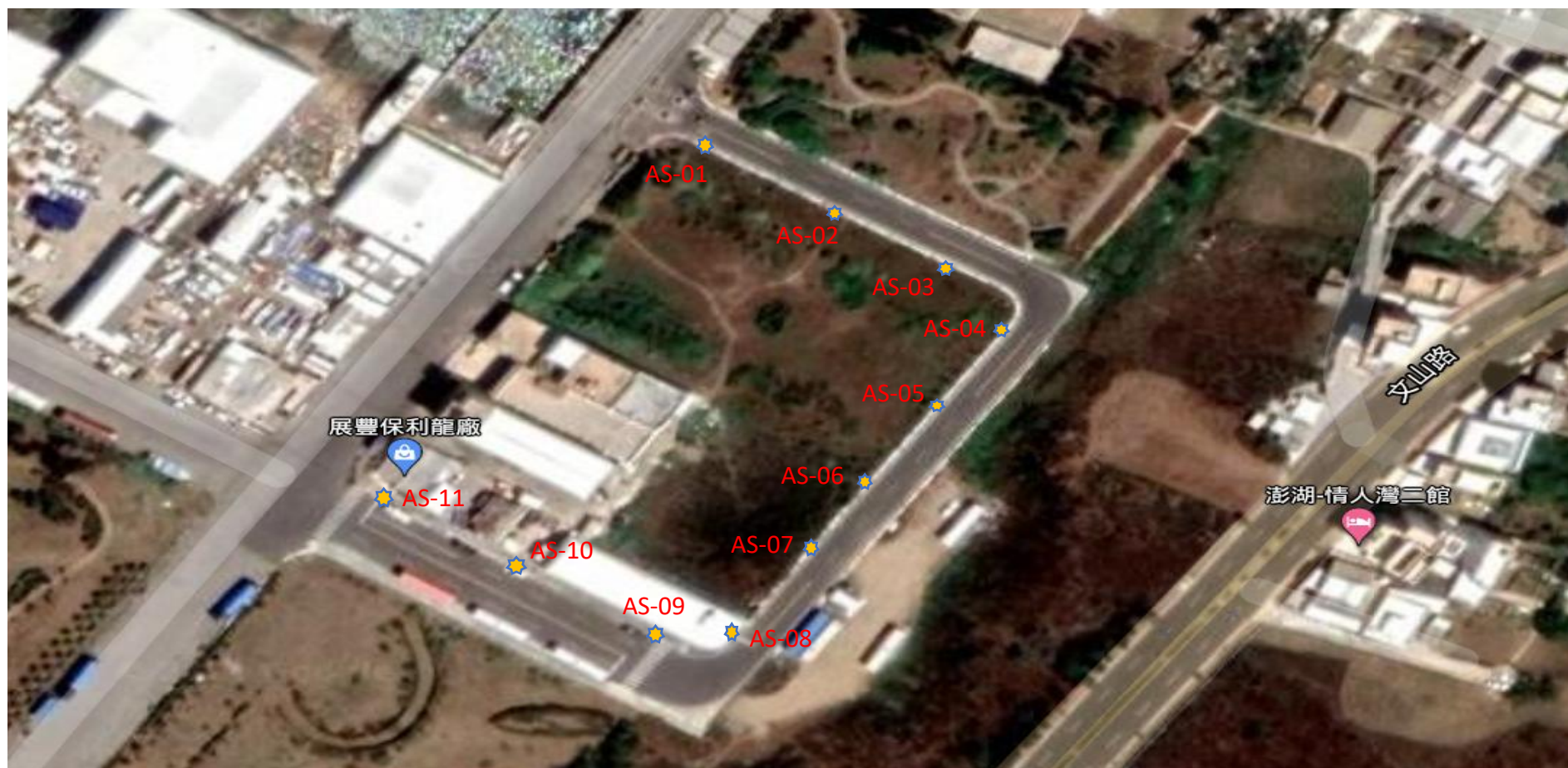
圖 3--案山工業區周邊道路共同管溝 260m，手孔 11 處。
