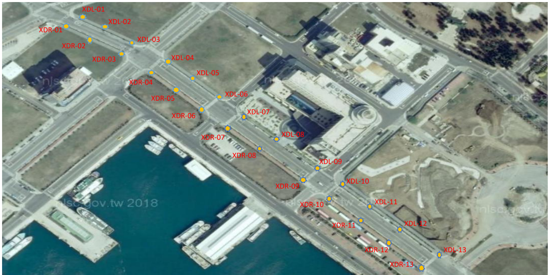
圖 6-1--新店路共同管溝 1103m，左側手孔 27 處、右側手孔 26 處。
