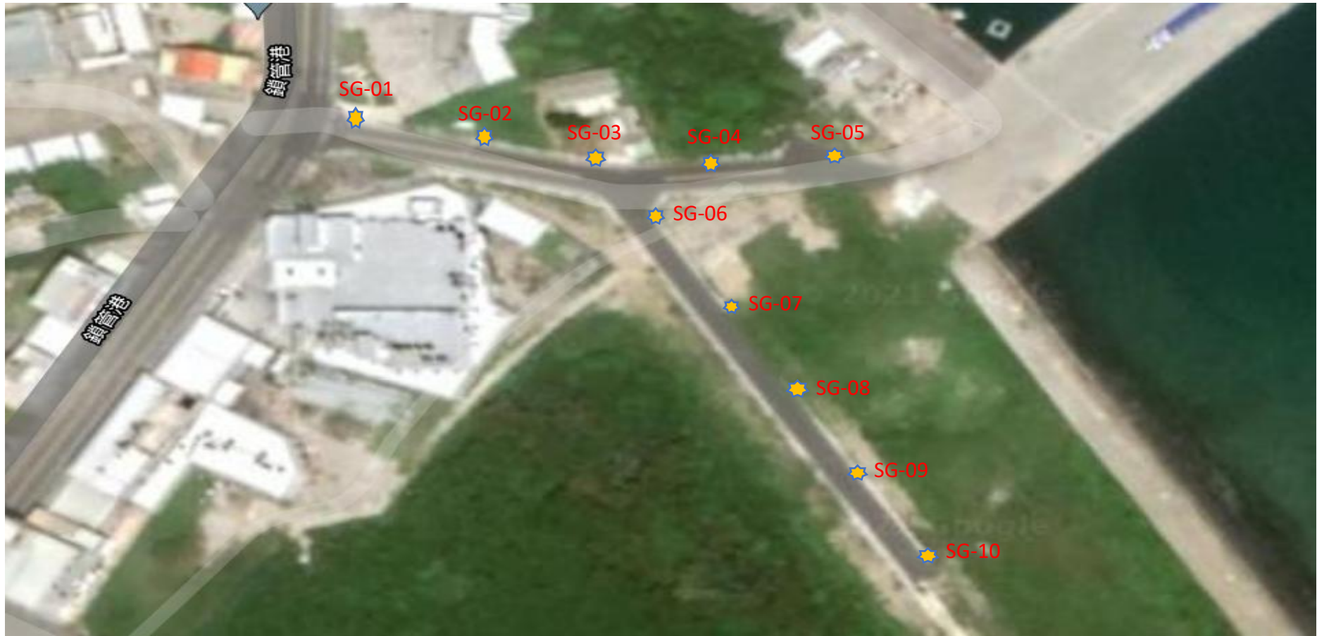
圖 4--鎖港工業區周邊道路共同管溝 230m ，手孔 10 處。
