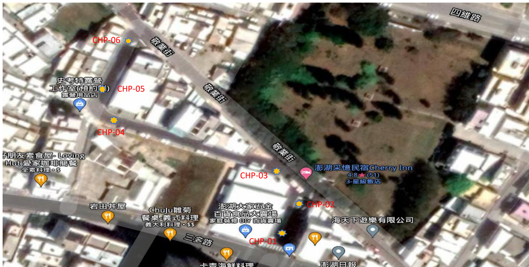
圖 5--春暉公園周邊道路共同管溝 168m，手孔 6 處。
