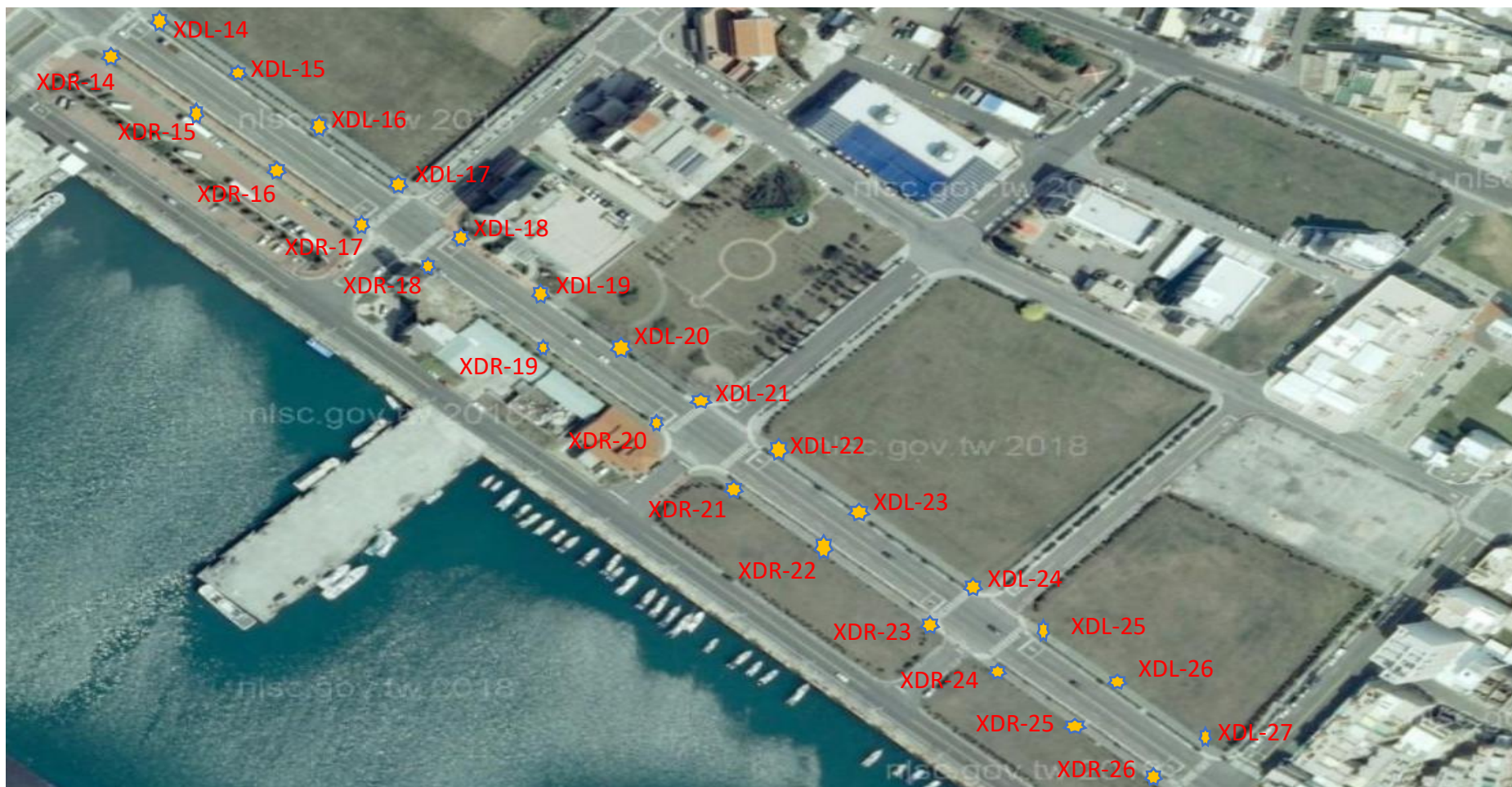
圖 6-2--新店路共同管溝 1103m，左側手孔 27 處、右側手孔 26 處。
